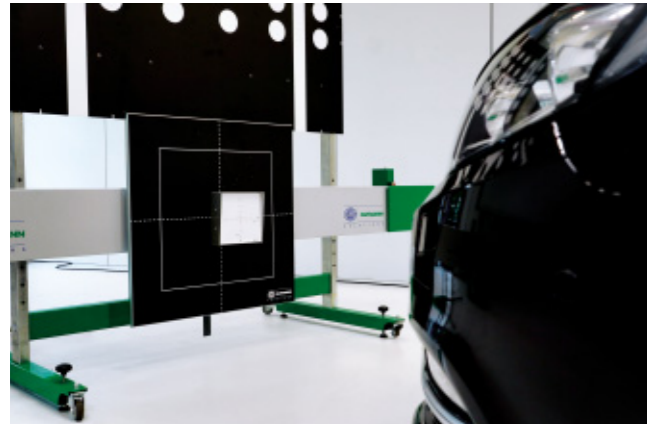
Szögbeállító lap különböző gyártók radarrendszereihez
