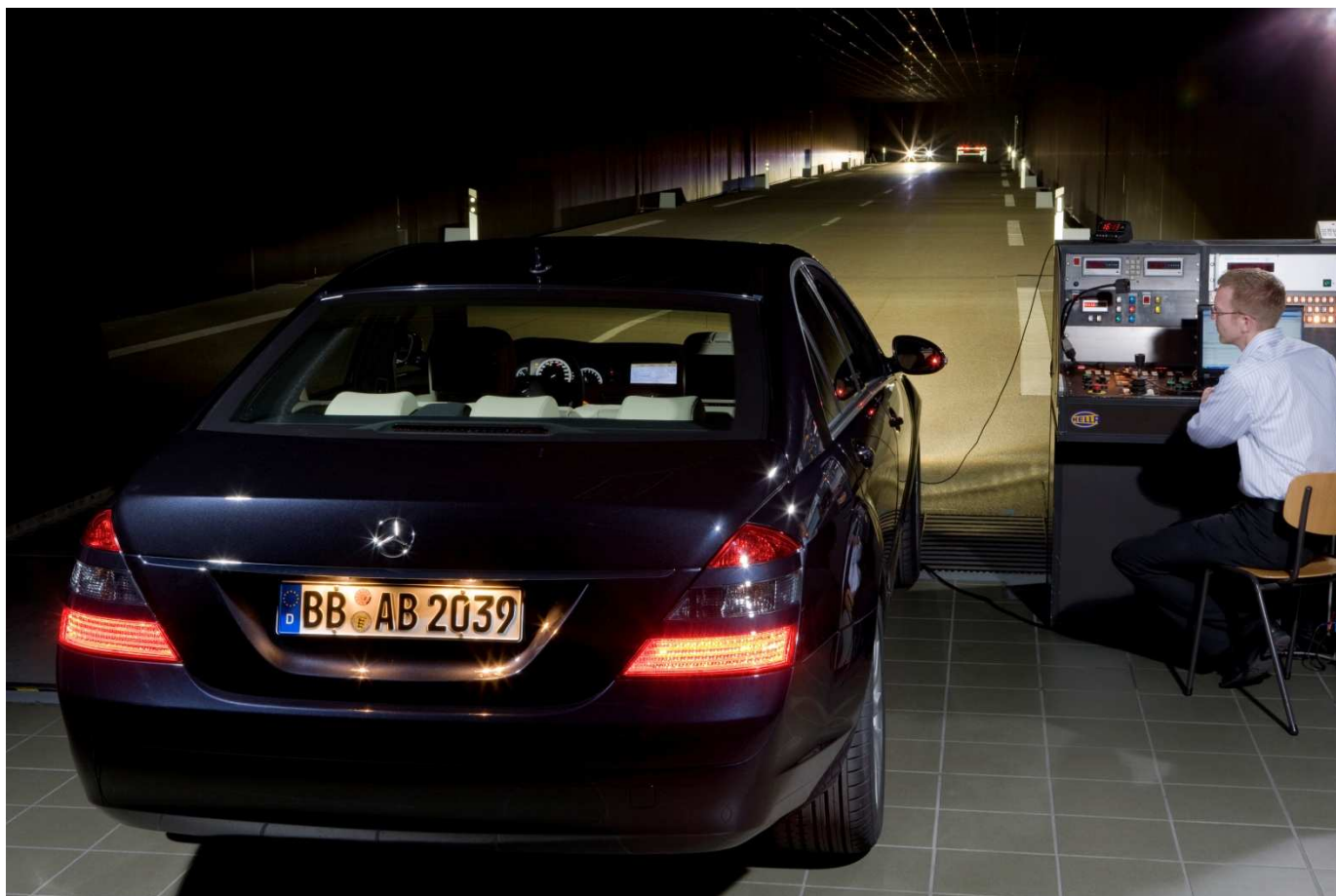
A fényelosztás bemutatása a Hella fénycsatornájában
